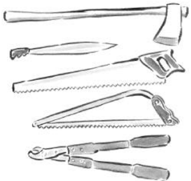
a) outils à main : hache, sabre ou machette, cisailles à long manche, scie à émonder et scie à main.
