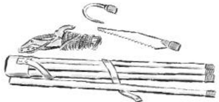
b) échenilloir et accessoires : perches pour allonger le manche afin de l'utiliser avec une scie à émonder, cisaille à long manche et un crochet qui sont tous attachés avec un pas de vis
